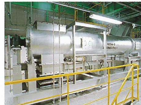
■冷却スクルー 熱分解ドラムから出た熱分解カーボンと不燃物を約80℃まで冷却します。
