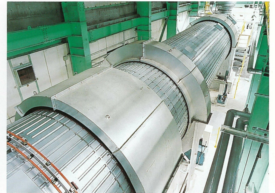
■熱分解ドラム ごみを空気のない状態で約1時間、450℃で蒸し焼きにして熱分解ガスとカーボンに改質します。
